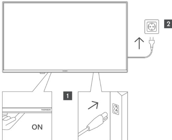
Stecken Sie ein Ende (den Stecker mit zwei Löchern) des mitgelieferten abnehmbaren Netzkabels in den Netzeingang auf der Rückseite des Fernsehers, wie oben gezeigt. Stecken Sie dann das andere Ende des Netzkabels in die Netzsteckdose. Das Fernsehgerät schaltet in den Standby-Modus.
