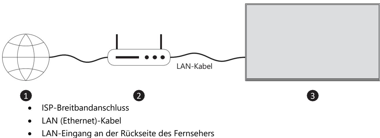
Je nach Konfiguration Ihres Netzwerks können Sie Ihr Fernsehgerät möglicherweise an eine Netzwerksteckdose anschließen. In diesem Fall können Sie Ihr Fernsehgerät über ein Ethernet-Kabel direkt mit dem Netzwerk verbinden.
