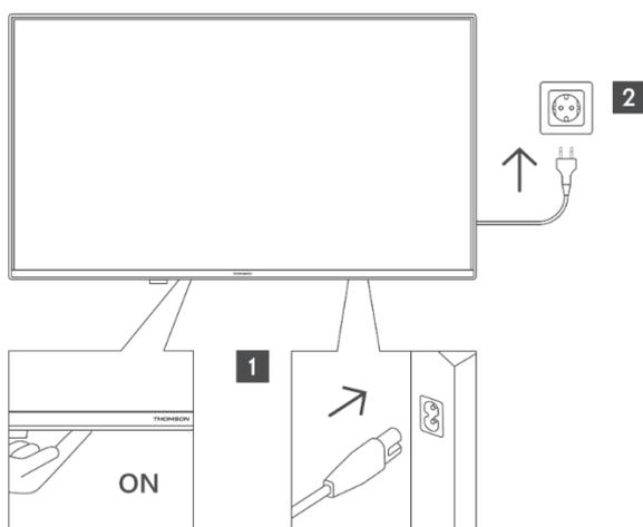
Branchez une extrémité (la fiche à deux trous) du cordon d'alimentation détachable fourni dans l'entrée du cordon d'alimentation située à l'arrière du téléviseur, comme indiqué ci-dessus. Branchez ensuite l'autre extrémité du cordon d'alimentation dans la prise de courant. Le téléviseur passe en mode veille.
