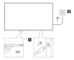
Inserire un'estremità (la spina a due fori) del cavo di alimentazione staccabile in dotazione nell'ingresso del cavo di alimentazione sul lato posteriore del televisore, come mostrato sopra. Inserire quindi l'altra estremità del cavo di alimentazione nella presa di corrente. Il televisore passa in modalità standby.
