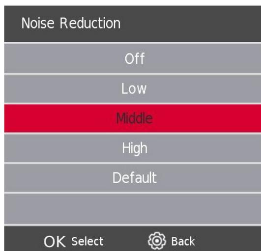
Ce réglage permet de filtrer et de réduire le bruit de l'image et d'améliorer la qualité de l'image. Appuyez sur la touche ▼ / ▲ pour sélectionner Réduction du bruit, puis appuyez sur la touche **OK** pour accéder au sous-menu.
