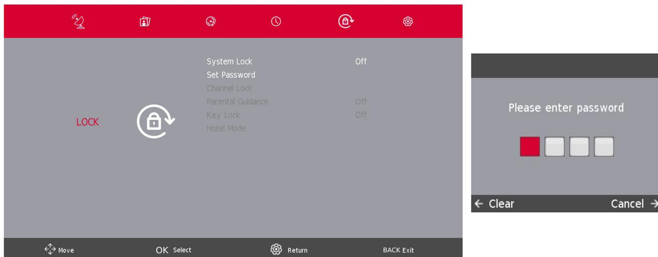
Voici des captures d'écran Pour que les options puissent être sélectionnées, le verrouillage du système doit être activé, par **défaut du téléviseur 1111**. Le verrouillage du système est maintenant actif.
