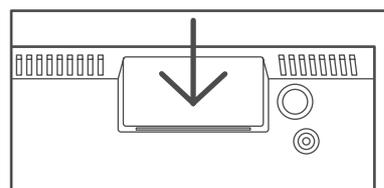
**Nota:** Si el modelo tiene una ranura para tarjeta CI en la parte superior, en la bolsa de accesorios encontrará un tapón de silicona para la ranura de la tarjeta CI (para los modelos sin ranura para tarjeta CI, no se suministra), inserte el tapón de silicona en la ranura cuando la tarjeta CI no esté en uso.
